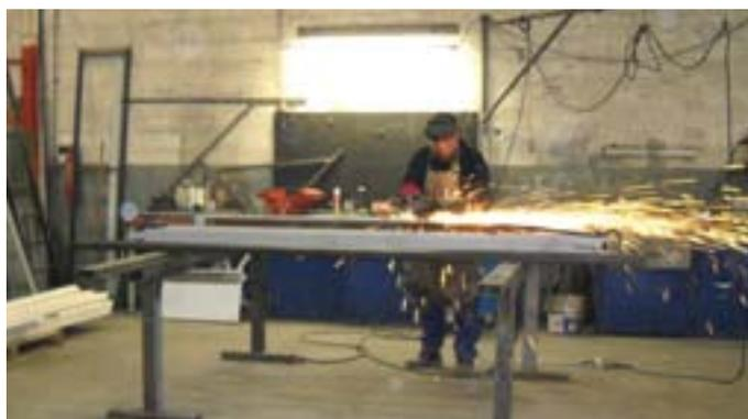
FIGURE 79 : OPÉRATEUR MEULANT AVEC UNE VISIÈRE DE PROTECTION
