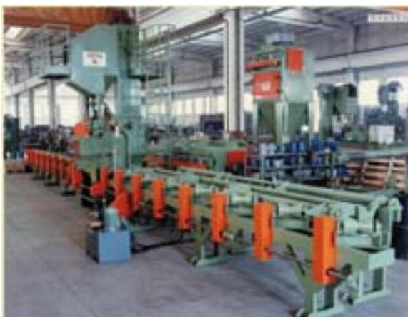
FIGURE 11 : GRENAILLEUSE MONO-BARRE LONGUEUR 12 MÈTRES
