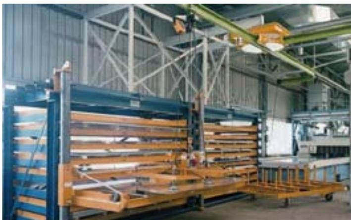
FIGURE 90 : SYSTÈME À TIROIRS MANUELS AVEC PALONNIER À VENTOUSES
