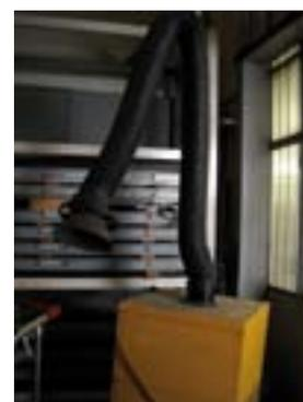
FIGURE 75 : SYSTÈME D'ASPIRATION LOCALISÉ MOBILE AVEC BRAS ASPIRANT
