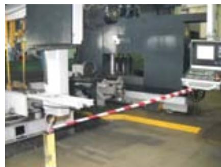
FIGURE 26, 27 ET 28 : CARTER MÉTALLIQUE, CARTER PLASTIQUE ET BARRIÈRE DE PROTECTION
