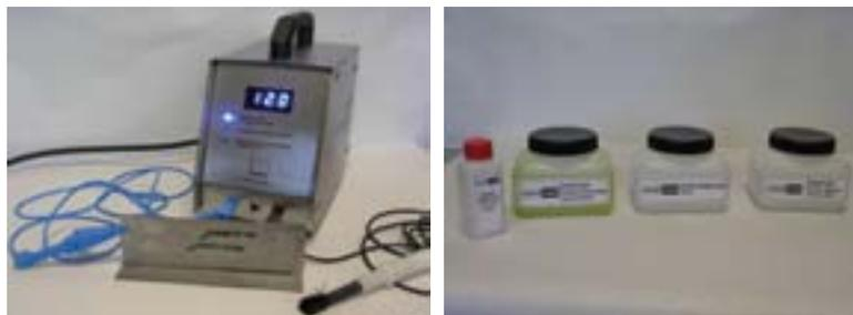
FIGURES 124 ET 125 : MATÉRIELS DE DÉCAPAGE ÉLECTROLYTIQUE
