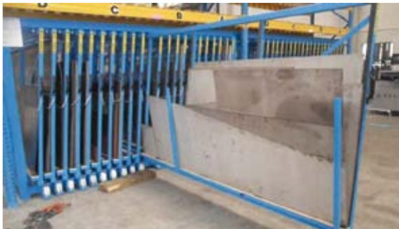
FIGURE 87 : STOCKAGE VERTICAL DE TÔLES
