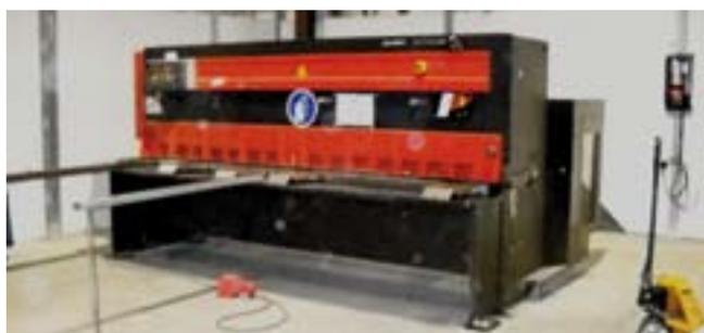
FIGURE 103 : EXEMPLE DE POSITION DE CISAILLE AVEC GRILLE DE PROTECTION À L'AVANT
