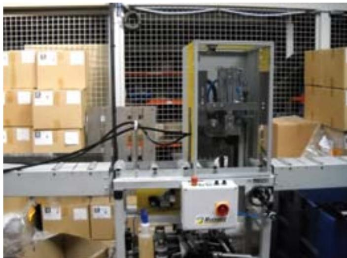
FIGURE 82 : JOINTEUSE
