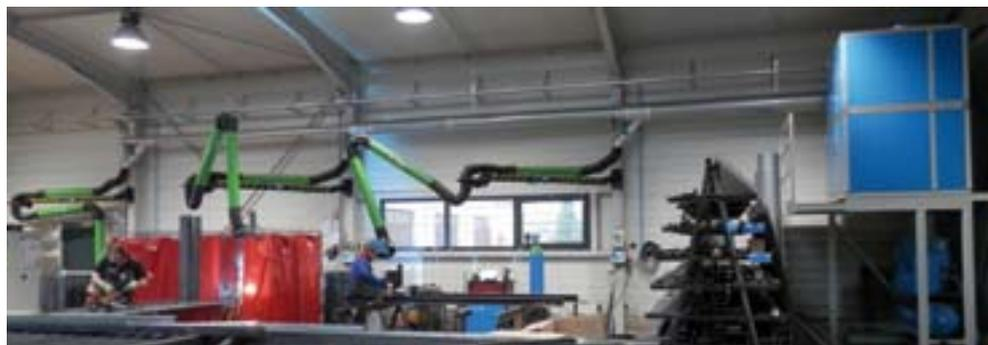
FIGURE 74 : SYSTÈME D'ASPIRATION CENTRALISÉE (À DROITE) AVEC BRAS ASPIRANTS
