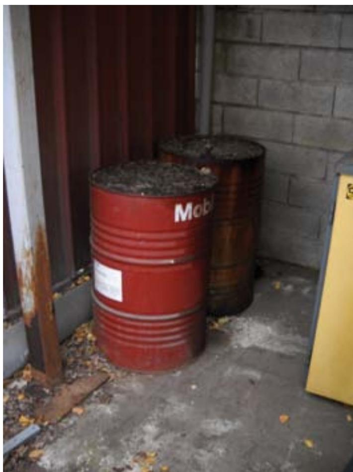
FIGURE 148 : BIDONS D'HUILE USAGÉE NON TRAITÉE SANS BAC DE RÉTENTION
