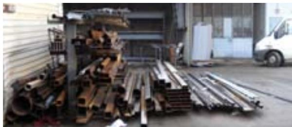
FIGURE 12 : STOCKAGE À L'EXTÉRIEUR SUR SOL IMPERMÉABLE SANS PROTECTION CONTRE LA PLUIE
