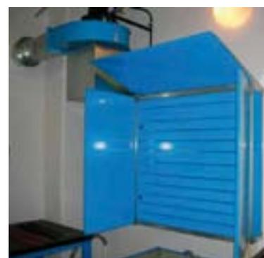
FIGURE 69 : EXEMPLE DE PANNEAU D'ASPIRATION
