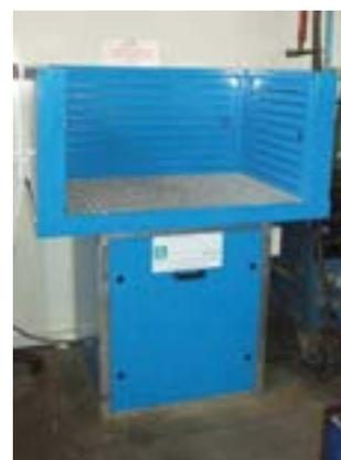
FIGURE 68 : EXEMPLE DE TABLE ASPIRANTE POUR SOUDAGE
