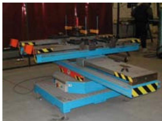
FIGURE 59 : TABLE DE MONTAGE ROTATIVE
