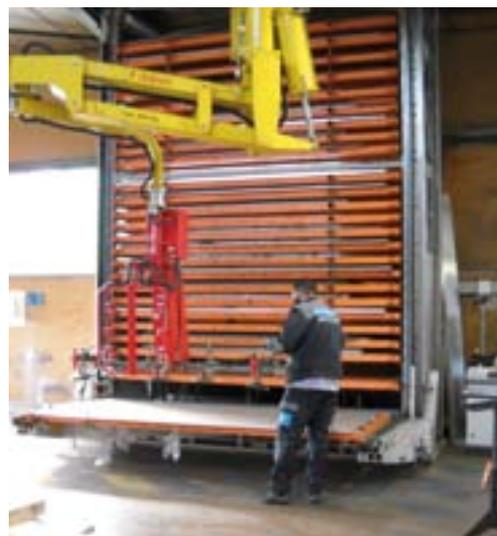
FIGURES 91, 92 ET 93 : TOURS DE STOCKAGE AVEC PALONNIER ASSISTÉ À VENTOUSES OU TABLE ROULANTE
