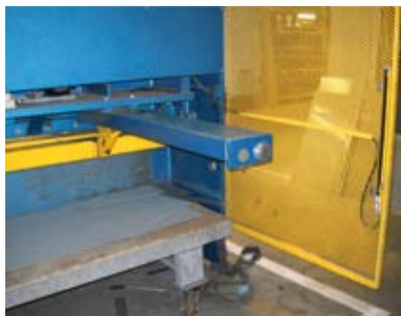
FIGURE 104 : SYSTÈME DE RÉCUPÉRATION DES DÉCOUPES AVEC LASER ARRIÈRE ET CELLULE DE DÉTECTION
