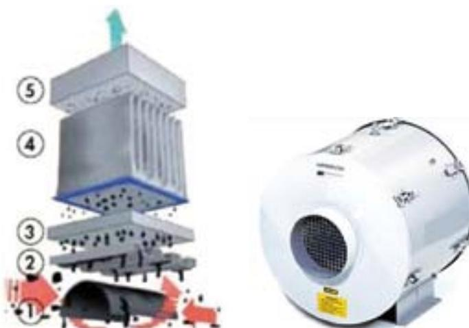
FIGURE 44 : PRINCIPE DU FILTRE À HUILE
